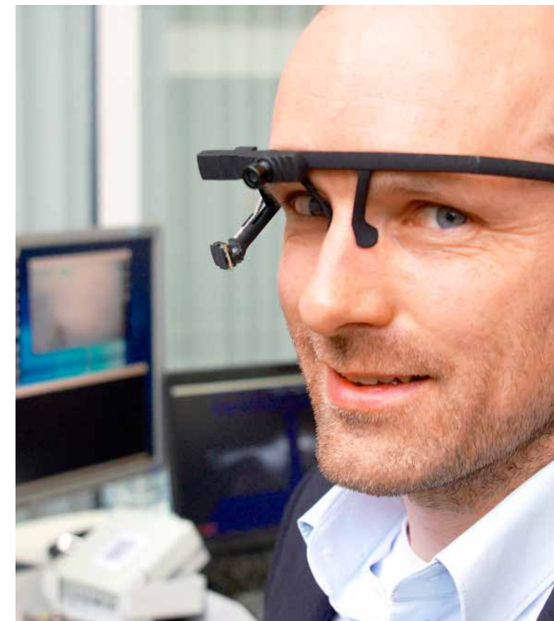
Die Kamerabrille schaut nach vorne, aber auch auf die Pupille des Brillenträgers – ein neues System zur Steuerung von Arbeitsprozessen.
