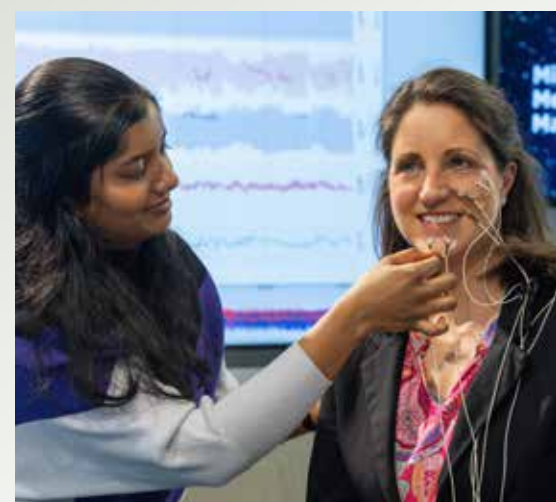
Was bewegt sich im Gesicht? Rathi Adarshi Rammohan von der Uni Bremen legt Kristina Brandstädter (WFB-Projektleiterin) Elektroden für eine Biosignal-Messung an, mit denen Muskelaktivitäten im Gesicht gemessen werden können.
