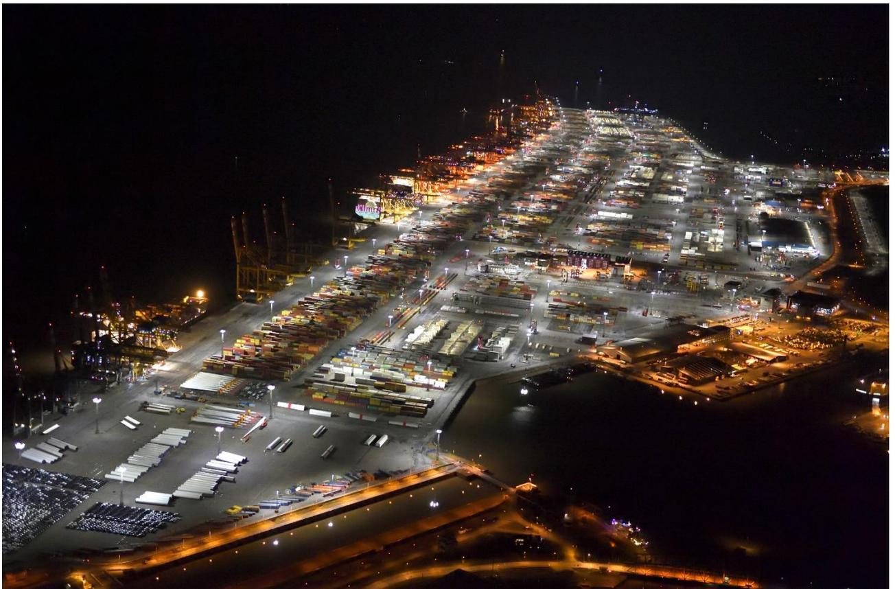
Das weiße LED-Licht beleuchtet den Containerterminal Bremerhaven viel heller als die alten Natriumdampflampen. © WFB/bremenports
