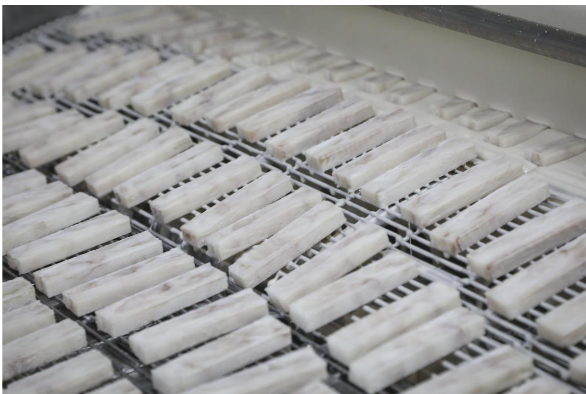
Am Anfang eines jeden Fischstäbchens steht ein 7,5 Kilo schwerer tiefgefrorener Block. Eine Säge zerteilt den gefrorenen Fischblock in kleine Rohlinge. © WFB/Focke Strangmann
