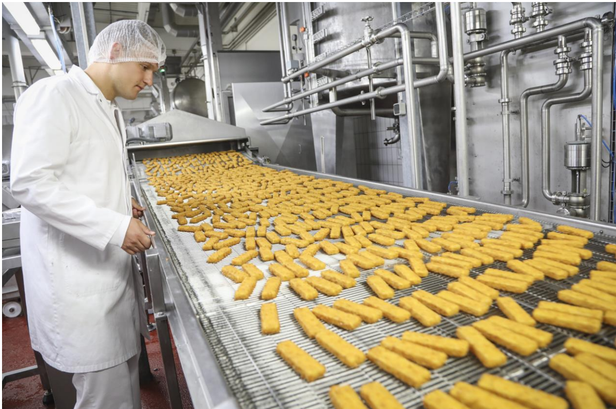
Produktion heute bei Frosta: Mitarbeiter Christoph Roes prüft die stets 9 Zentimeter langen, 2,6 Zentimeter breiten und 1,1 Zentimeter hohen Fischstäbchen. © WFB/Focke Strangmann
