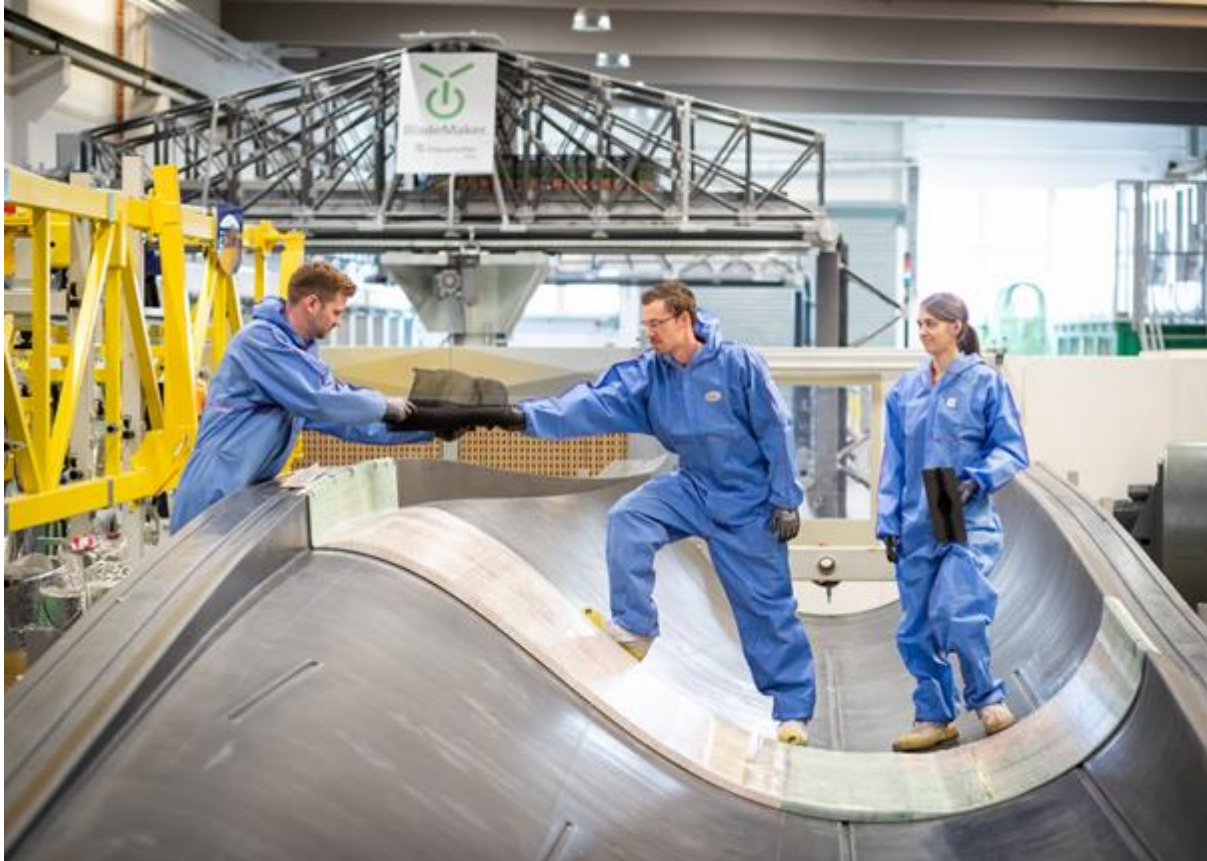
Das IWES verfügt in Bremerhaven über eine eigene Fertigungshalle. Dort werden Materialien und Verfahren getestet, um die Abläufe in der Produktion zu vereinfachen und die Fertigungsqualität zu steigern. © Fraunhofer IWES/Jan Meier
