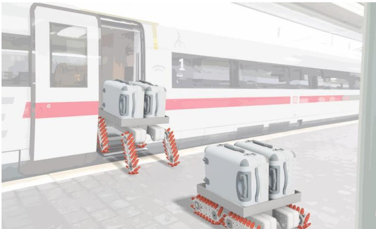
Ein kleines autonomes Kettenfahrzeug soll an Haltestellen bereitstehen und einen oder zwei Koffer transportieren können. © BIBA
