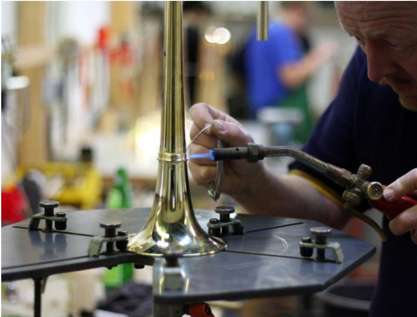
Olav Brandt lötet Teile einer Trompete zusammen. © WFB/Berit Böhme
