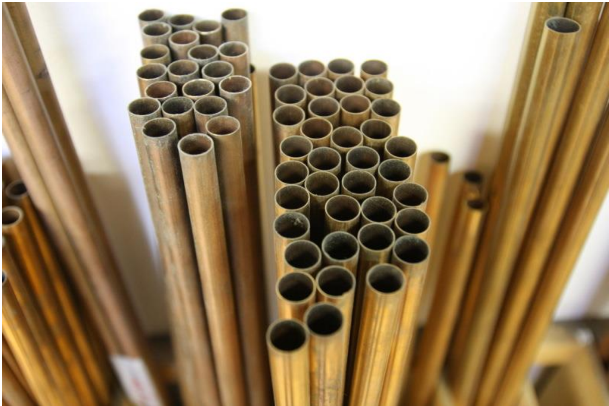
Thein Brass verarbeitet Messing mit drei unterschiedlich hohen Kupferanteilen. © WFB/Berit Böhme
