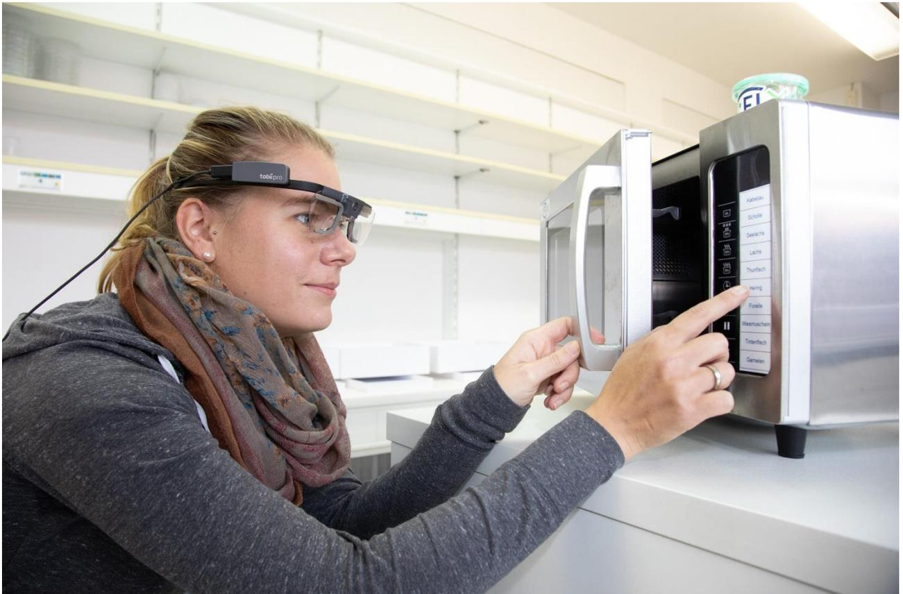
Mithilfe einer Eyetracking-Brille untersucht das ttz, ob die Bedienelemente einer Mikrowelle sinnvoll angeordnet sind. © WFB/Jens Lehmkühler
